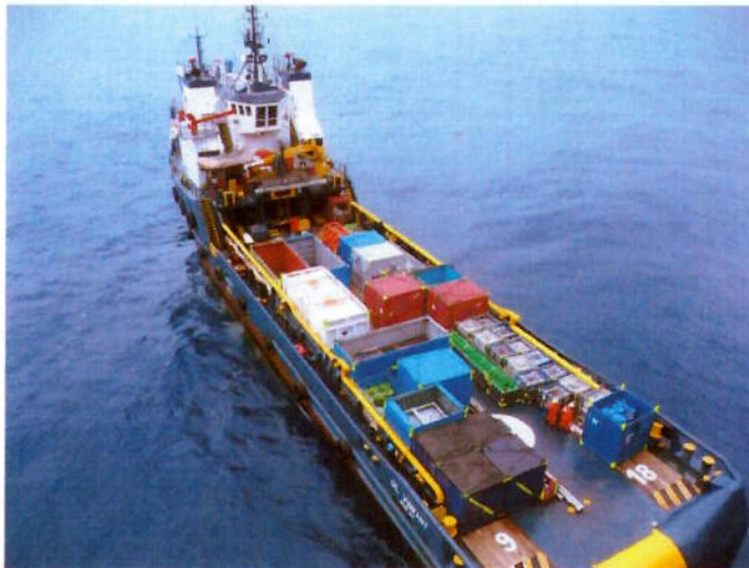
Figura 8: MPSV com carga no convés adequada ao manuseio de âncoras (Fonte: Kempin, 2012).
